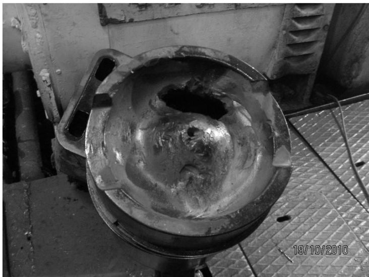
Рис. 1. Повреждение поршня цилиндра № 6 дизеля 6ЧН 18/22-225
