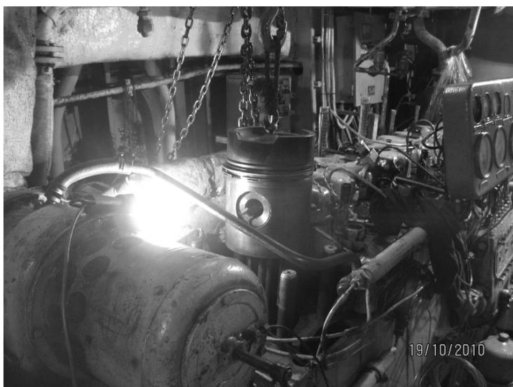
Рис. 3. Демонтаж поршня дизеля 6ЧН 18/22-225
