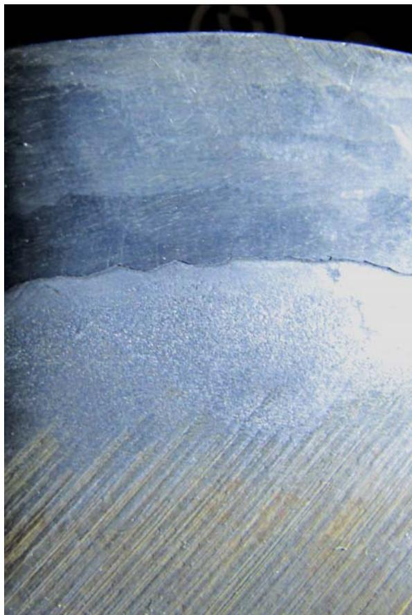
Рис. 3. Макрошлиф. Строение наплавки (просматриваются 4 слоя)
