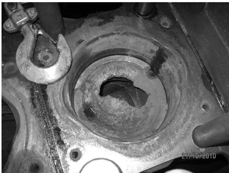
Рис. 4. Повреждение поршня цилиндра № 5 дизеля 6ЧН 18/22-225
